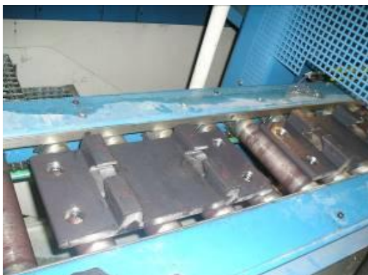
Szczegół przenośnika wałeczkowego obrabianymi przedmiotami
