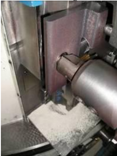
Bohren der Bohrung
