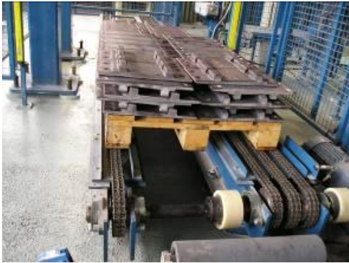
Detail des Förderers für Paletten mit Werkstücken
